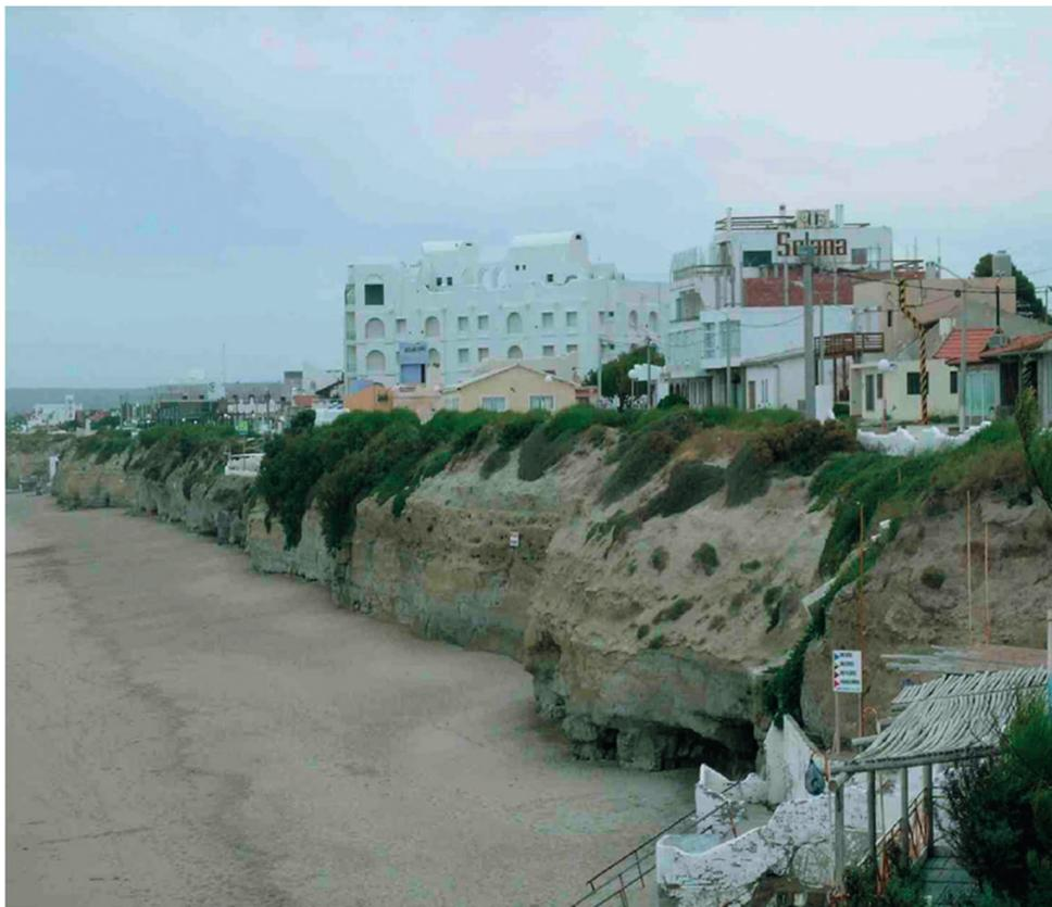
Figura 10, Se aprecia la erosión activa sobre el acantilado potenciado por la actividad antrópica entre otras la construcción de rampas de acceso.
