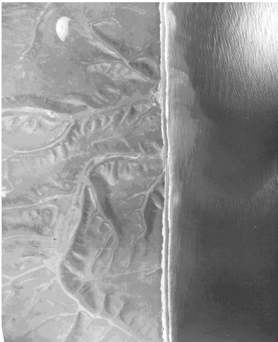
Figura 6. En la imagen aérea se observa el truncamiento de la red de drenaje ocasionado por el activo retroceso del acantilado. Fotografía del SHN 1968.
